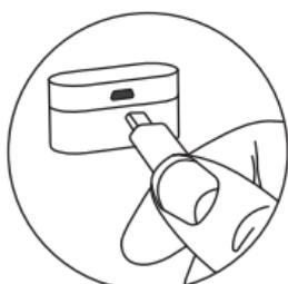
Connettere un cavo micro USB alla custodia di ricarica. Connettere l'altro capo del cavo al caricabatterie del vostro cellulare o pc.
